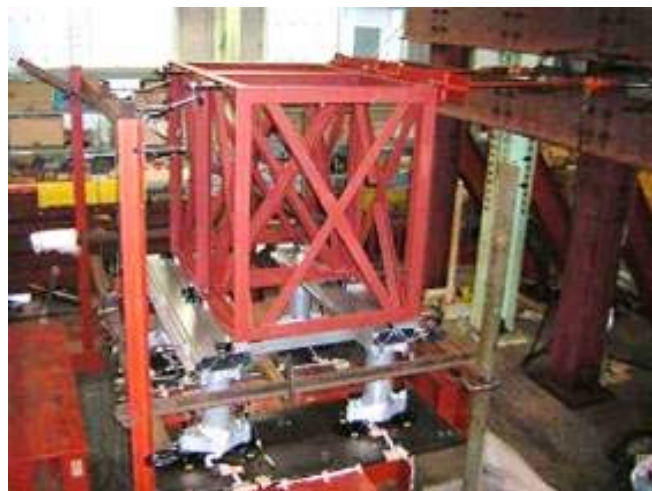
地震力を模した静的加力 試験の様子
